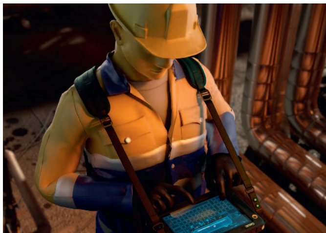
Рис. 5. Планшет EX80 на четырёхточечном ремне
