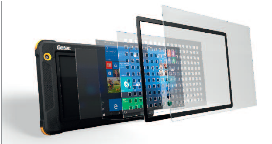
Рис. 3. Дисплей EX80 в разобранном виде
