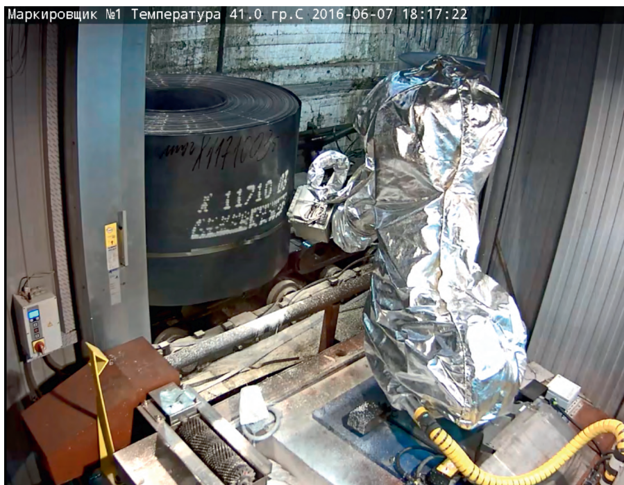
Рис. 2. Маркировка рулона БАР-кодом, вид из камеры распознавания
