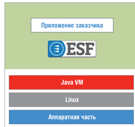
Рис. 2. Структура шлюза IoT
