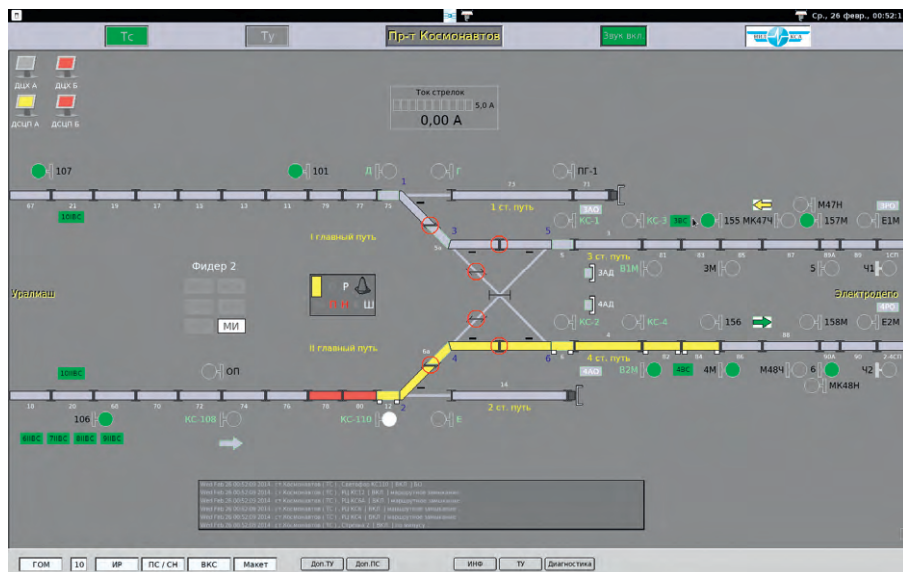
Рис. 10. Копия экрана АРМ ДСЦП станции «Прспект Космонавтов»
