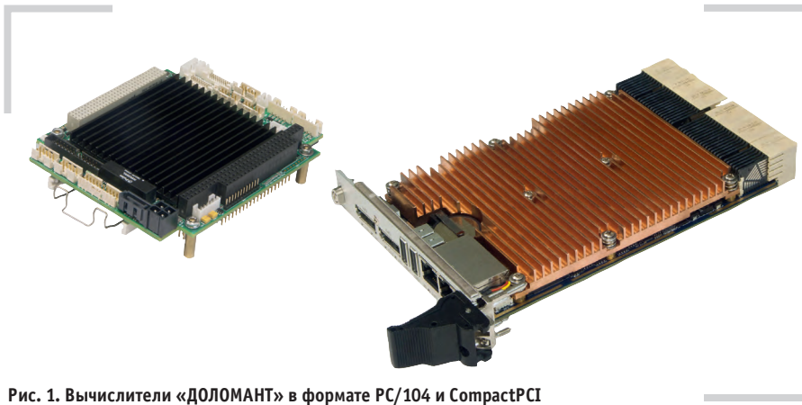
Рис. 1. Вычислители «ДОЛОМАНТ» в формате PC/104 и CompactPCI
