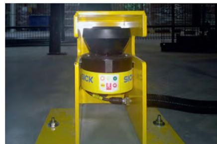
Рис. 4. Лазерный сканер безопасности
