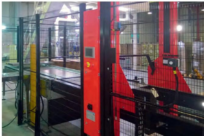
Рис. 2. Палетайзер с толкателем
