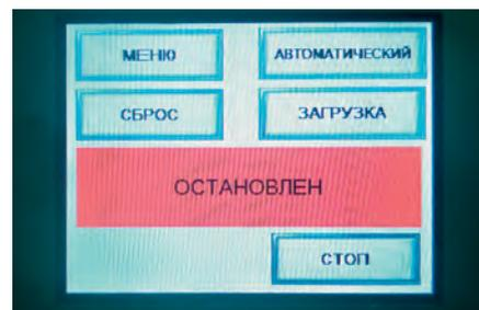
Рис. 3. Человеко-машинный интерфейс на базе сенсорной панели
