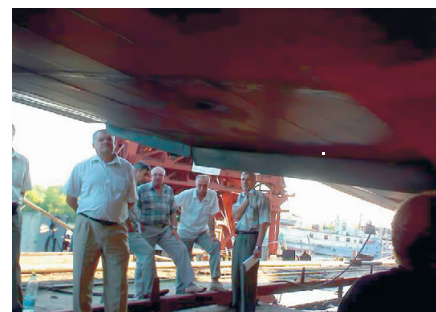
Рис. 1. Проверка работы интерцепторов скоростного теплохода на стапеле Зеленодольского судостроительного завода
