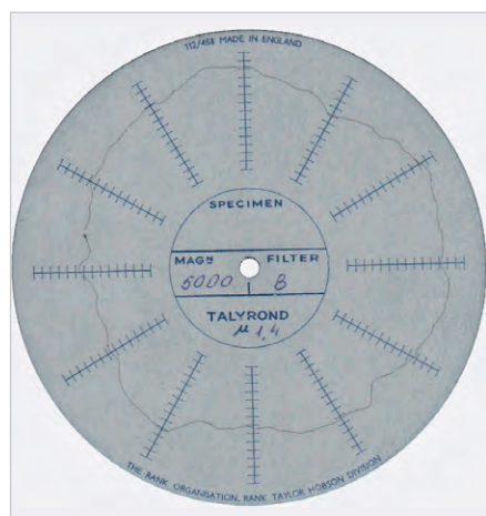
Рис. 2. Данные об отклонении обработанной шлифованием детали от круглой формы, полученные в виде круглограммы
