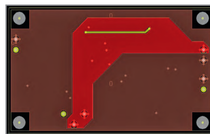
Рис. 33. Вид слоя Bottom после создания полигонов
