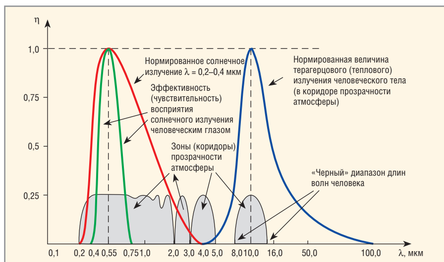
Рис. 3. Нормированные интенсивности мощности солнечного излучения (красный) и человеческого излучения (синий). Коридоры прозрачности атмосферы в видимом и ИК-диапазонах
