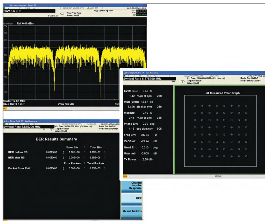
Рис. 3. Три сигнала несущих стандарта DVB-C с модуляцией 64QAM, одновременно сгенерированные генератором сигналов Keysight 33522B
