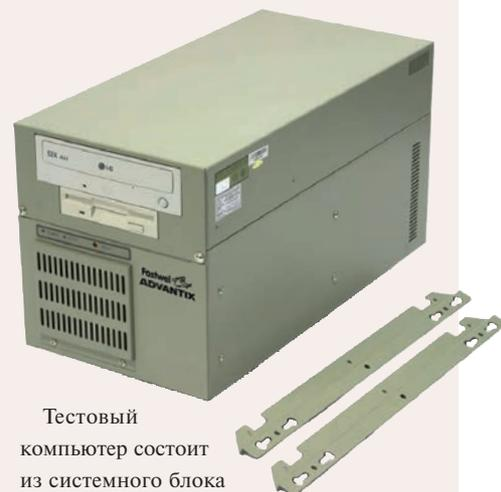
Тестовый компьютер состоит из системного блока на базе платы **iBase IB990AF** с набором системной логики **Intel C236**, процессора **Pentium G4400**, оперативной памяти **Kingston** объёмом 8 Гбайт и жёсткого диска объёмом 1 Тбайт. Тестирование проходило на базе операционной системы реального времени (OC PB) **QNX 6.5.0 SP1 BIOS American Megatrends** версии 2.18.1256.
