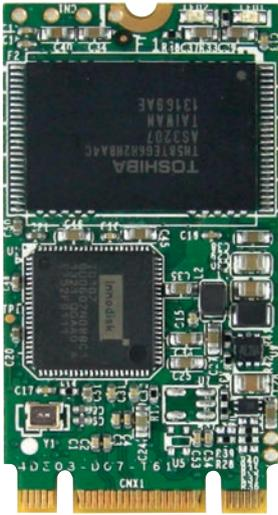
Рис. 1. Твердотельный накопитель
