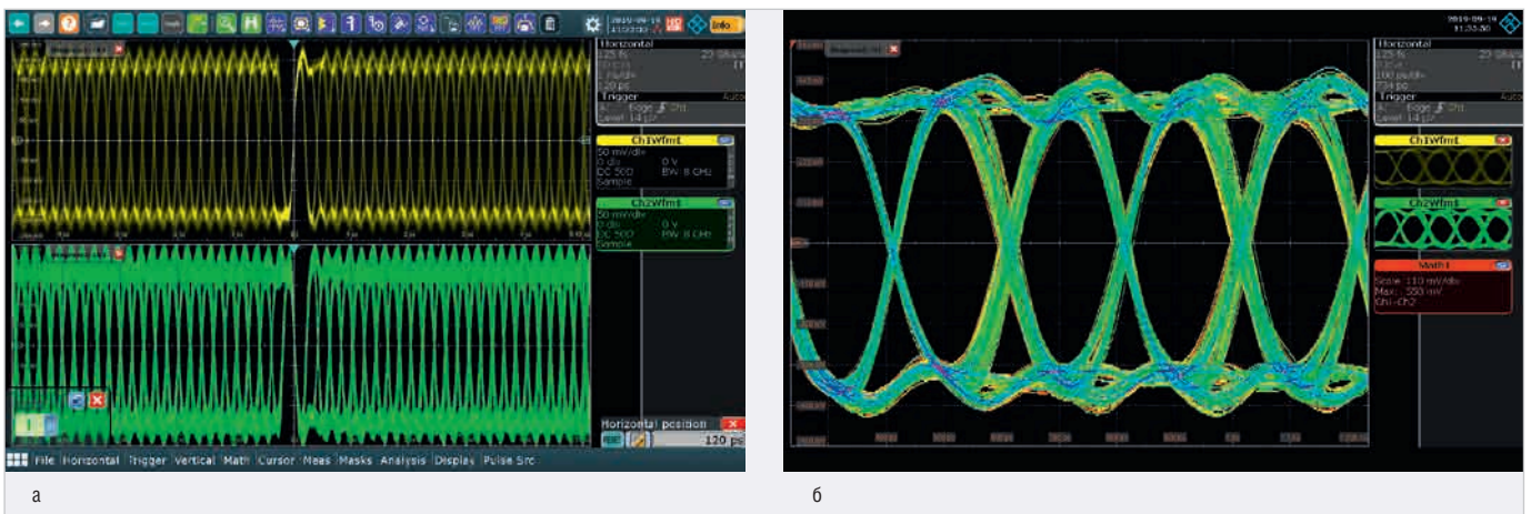
Рис. 8. Осциллограммы, полученные после активации функции Deembedding: а) сигналов в линиях Tx+ и Tx-; б) дифференциального сигнала
