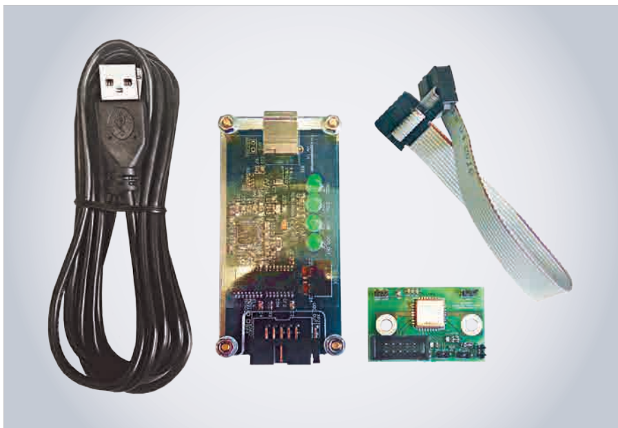
Рис. 5. Состав отладочного модуля на основе микросхемы K5331NH015
