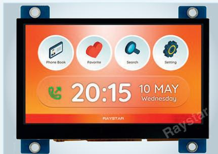
Обращаем ваше внимание, что в стандартной поставке модуля RFE43VW-1YH-DHG отсутствует разъём micro-HDMI, ввиду этого потребитель должен заранее подготовить переходник с micro-HDMI на HDMI.
