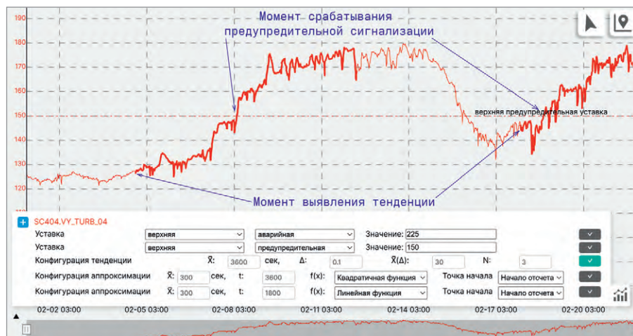
Рис. 2. Временная диаграмма с отображением результата работы функции выявления тенденции
