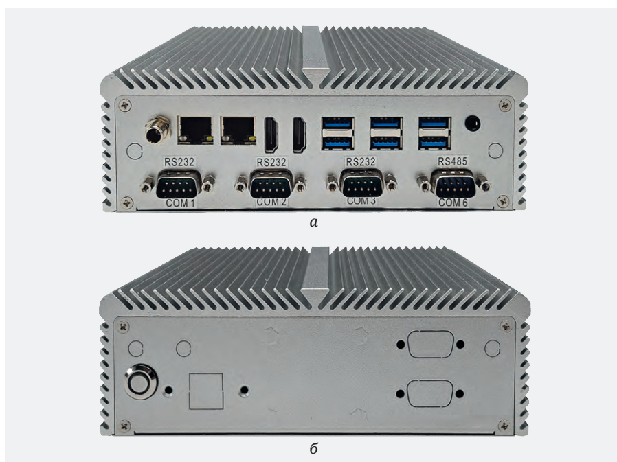
Рис. 1. Безвентиляторный промышленный компьютер ER-8200: а – вид спереди; б – вид сзади
