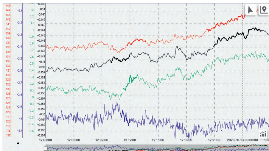
Рис. 9. Временная диаграмма вибро- и термопараметров турбины в момент возникновения аномалии в работе
