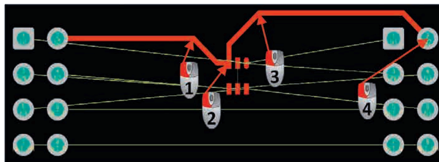
Рис. 2. Пример прокладки проводника
