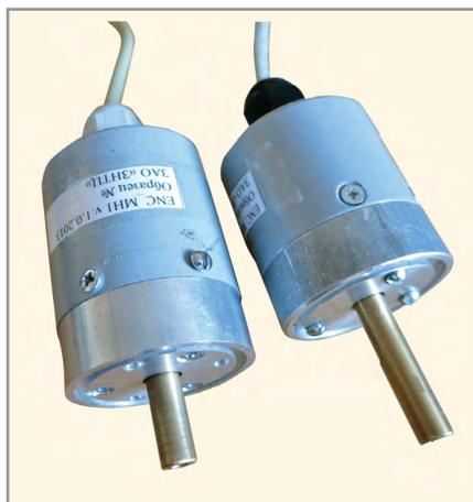
Рис. 6. Конструктив абсолютного энкодера положения на основе K1382HX045
