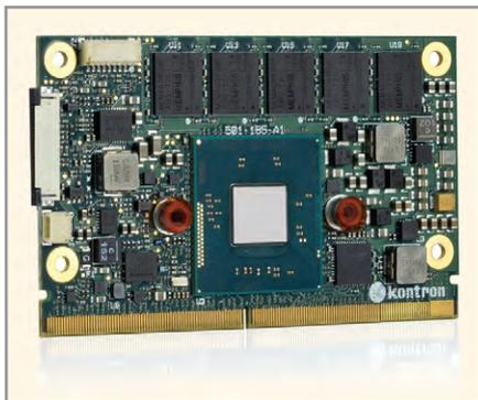
**Рис. 5. Компьютеры-на-модуле серии Kontron SMARC-sXB7i рассчитаны на эксплуатацию при температурах от -40 до +85°C**
