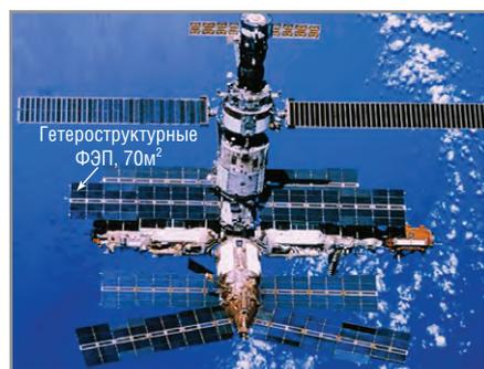
**Рис. 6. Космическая станция «Мир» с гетероструктурной AlGaAs/GaAs СБ, установленной на базовом модуле**
