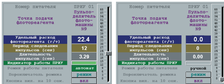
Рис. 5. Вид видеопульт управления питателем № 1 в автоматическом (слева) и ручном (справа) режимах
