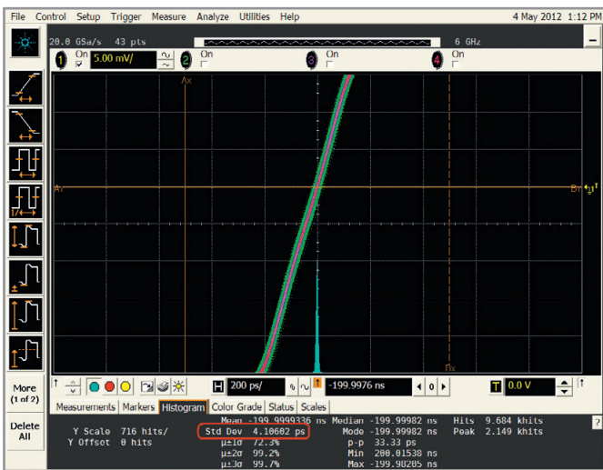
Рис. 3. Измерение джиттера сигнала, созданного по технологии Trueform
