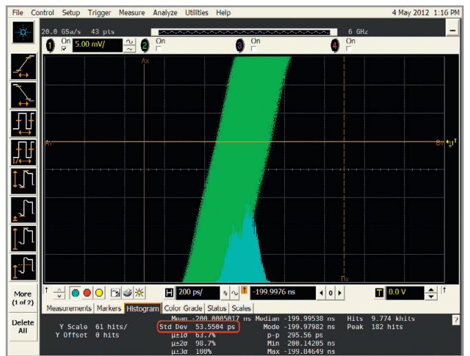
Рис. 4. Измерение джиттера сигнала, созданного по технологии DDS
