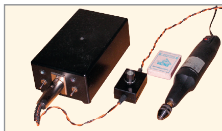
Рис. 7. Внешний вид тиристорного регулятора (в центре); слева (в большом корпусе) – трансформатор и выпрямитель
