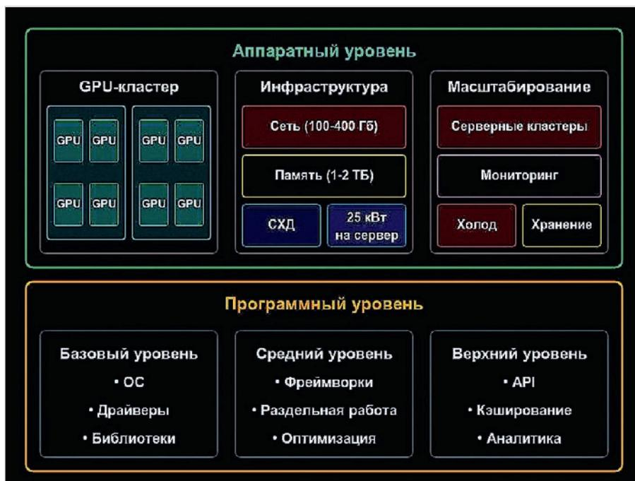
Рис. 4. Структурная схема аппаратной и программной частей современного ИИ
