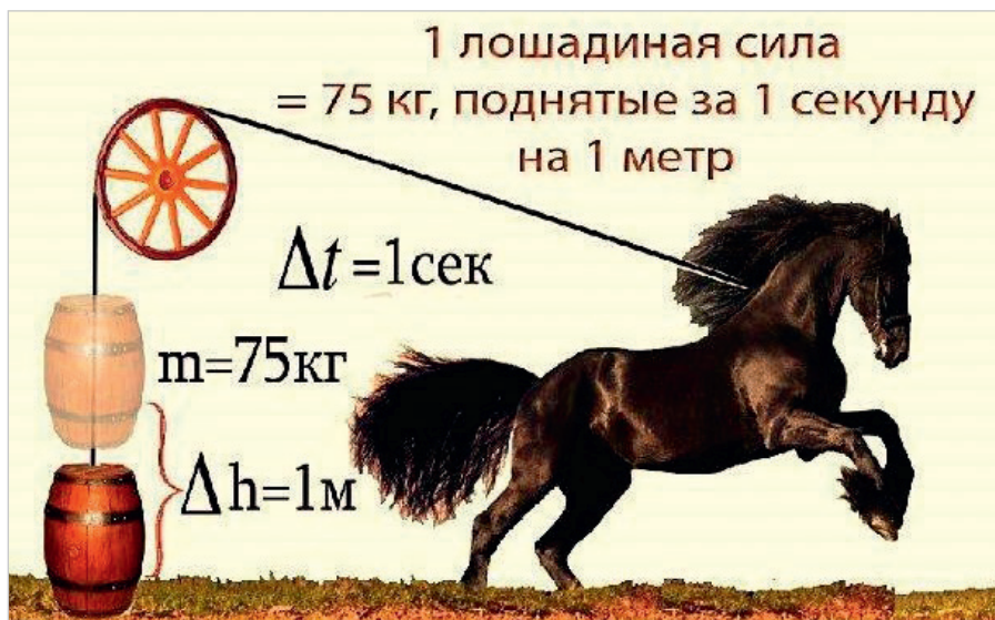
Рис. 5. Иллюстрация определения «лошадиной силы»
