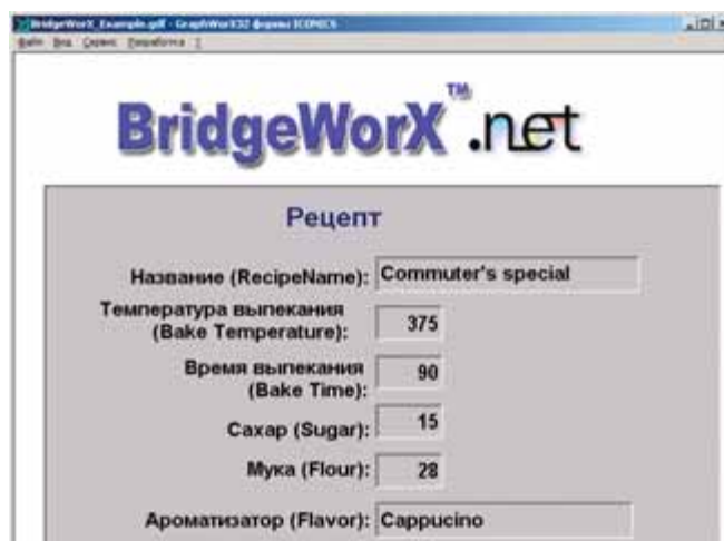
Рис. 68. Рецепт загружен — значения тегов OPC установлены
