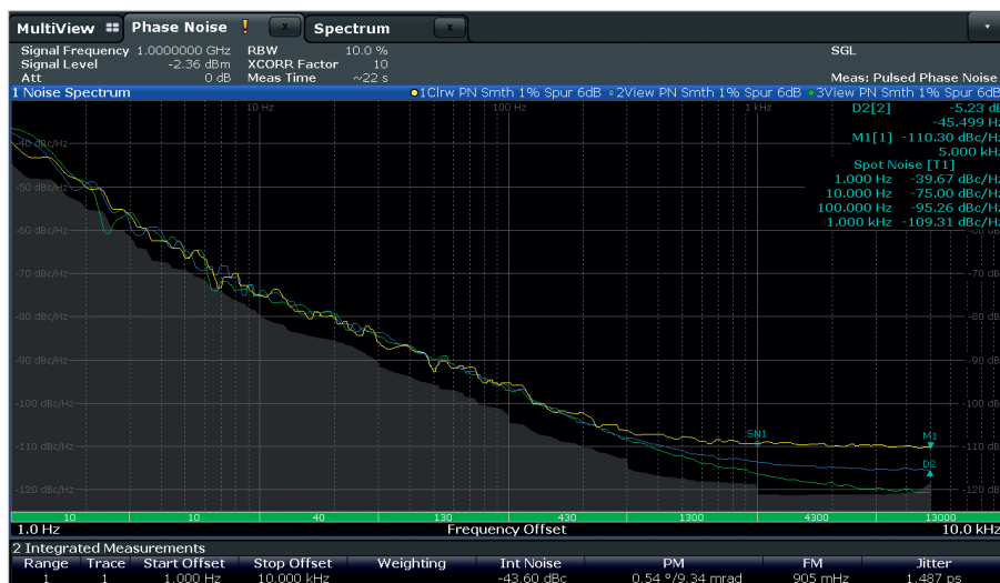
Рис. 6. Вариации фазового шума, вызванные изменением длительности импульса
