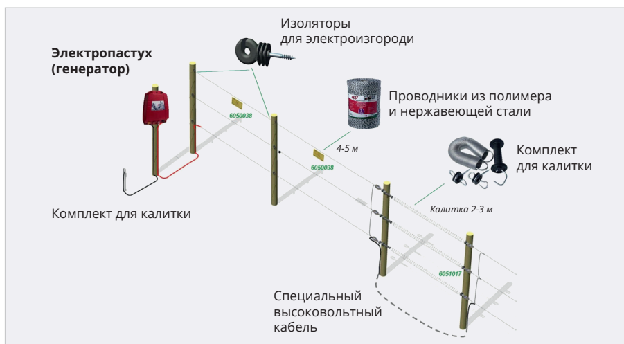
Рис. 9. Рекомендации по применению электронной системы «Электропастух»
