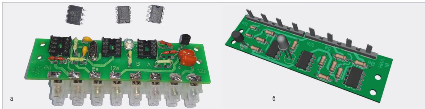
Рис. 6. Фото собранной платы преобразователя rs485-1wire (6а) и её 3D-модель в DipTrace (6б)
