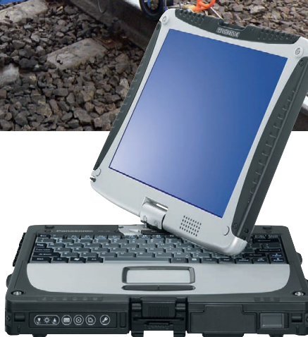
Рис. 6. Защищённый ноутбук Panasonic CF-19 – составная часть диагностической аппаратуры
