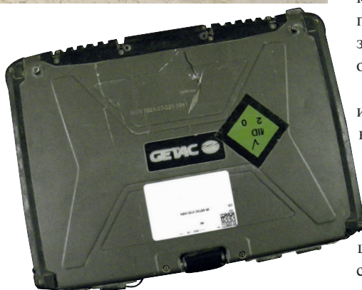
Рис. 8. Крышка ноутбука после попадания камня, отброшенного взрывной волной
