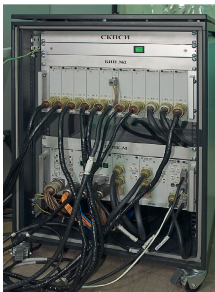
Рис. 5. Крепление блоков и модулей в стойке
