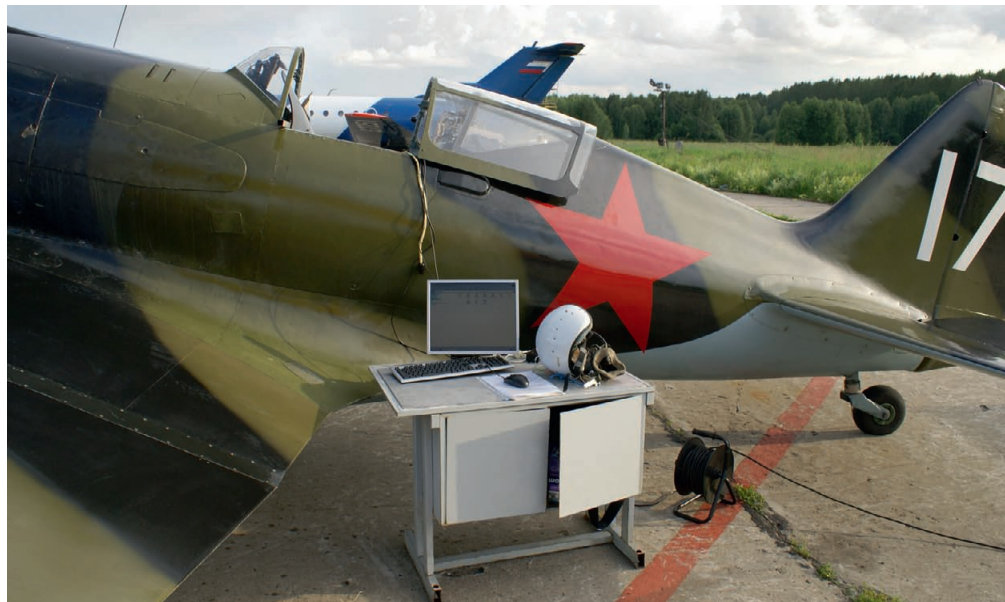
Рис. 11. Применение МСБИ при испытаниях самолёта-реплики МиГ-3
