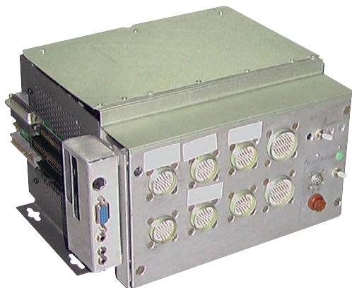
Рис. 1. Первый образец малогабаритной системы бортовых измерений
