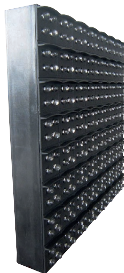
Рис. 4. Дискретно-вертикальный модуль светодиодного экрана
