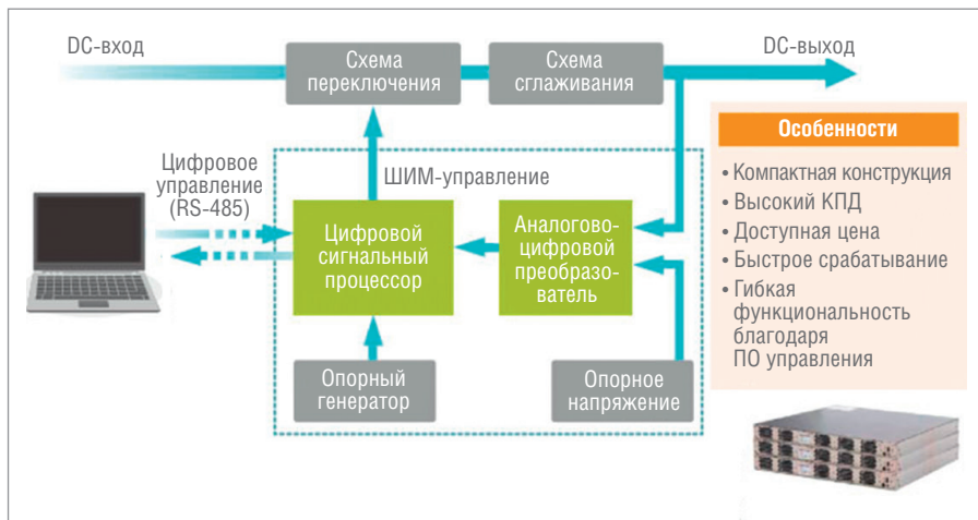
Рис. 3. Схема цифрового управления в двунаправленных DC/DC-преобразователях серии EZA
