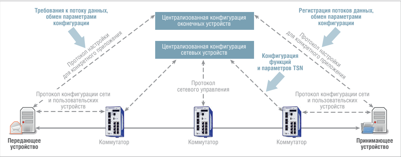
Рис. 4а. Вариант централизованной конфигурации TSN. Оконечные устройства обмениваются данными напрямую с сервером, задающим конфигурацию
