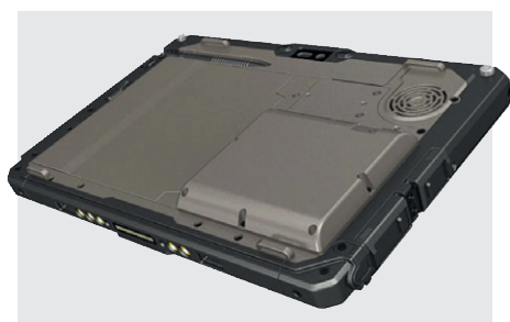
Рис. 6. Батарея-перемычка для возможности «горячей» замены
