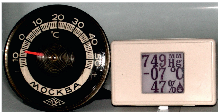
Рис. 13. Сравнение показаний уличного термометра и прибора, помещённых в морозилку холодильника
