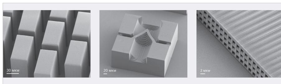
Рис. 20. Микроминиатюрные капиллярные системы, изготовленные методом 3D-печати
