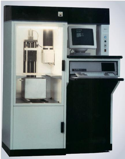
**Рис. 4. Первый 3D-принтер компании 3D-System**
