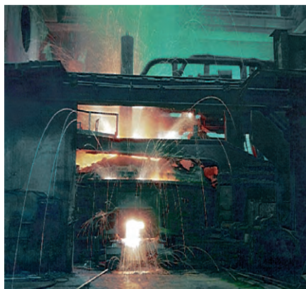
Дуговая сталеплавильная печь
