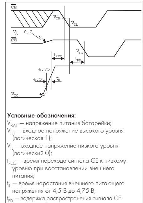
Рис. 3. Временные диаграммы перехода в режим хранения данных от внешнего источника
