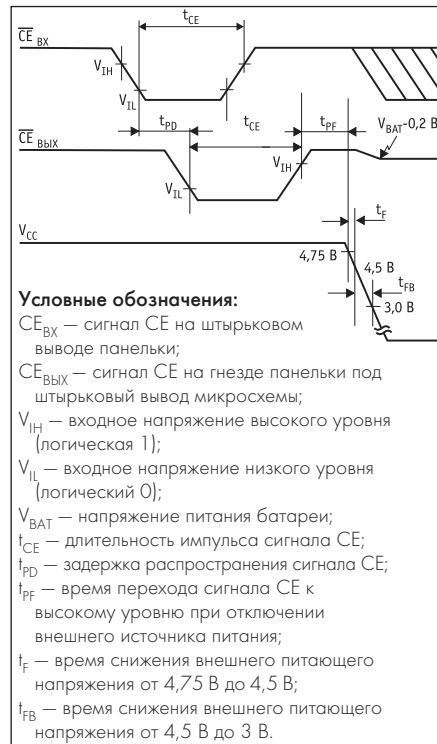
Рис. 2. Временные диаграммы перехода в режим автономного питания
