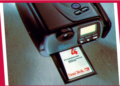
Флэш-диски серии SD-25 и SD-35 — идеальная замена традиционных IDE НЖМД в жестких условиях эксплуатации. Емкость от 32 до 1200 Мбайт.
