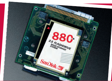
Флэш-диски серии SD-25 и SD-35 — идеальная замена традиционных IDE НЖМД в жестких условиях эксплуатации. Емкость от 32 до 1200 Мбайт.
