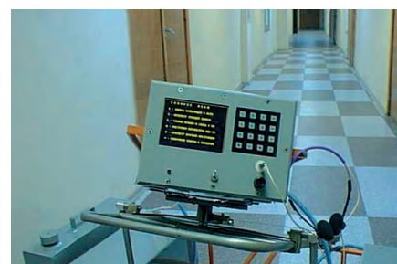
Рис. 5. Дисплей Planar EL640.480.AM8-ET в составе дефектоскопа АДС-02
