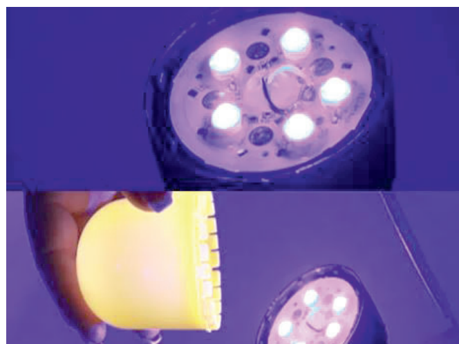
Рис. 5. Конструкция лампы-ретрофита, сделанной по технологии удалённого люминофора, с форм-фактором лампы накаливания
