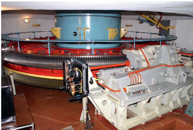
Рис. 4. Привод азимутальной оси с открытым отсчётным блоком
