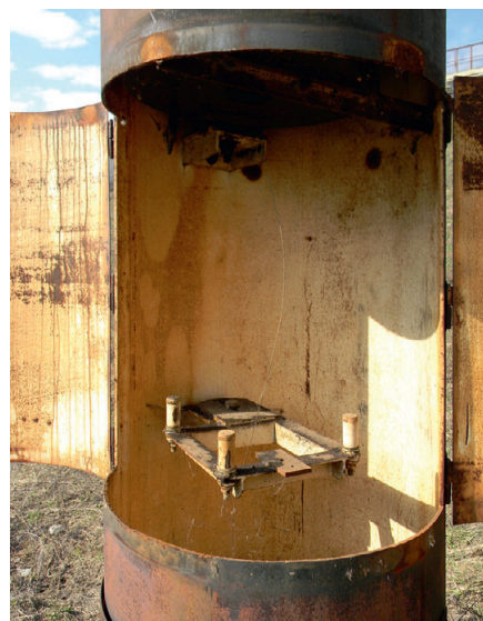
Рис. 2. Обратный отвес с оборванной нитью
