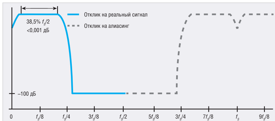
Рис. 13. Пример влияния эффекта наложения частот входного сигнала АЦП на отклик комбинации фильтров НВ1+НВ2, DCM=2 (вещественная часть)
