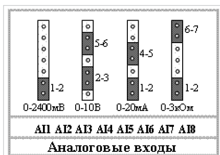
Рис. 4. Перемычки аналоговых входов AI
