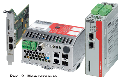
Рис. 2. Межсетевые экраны FL MGuard от Phoenix Contact
