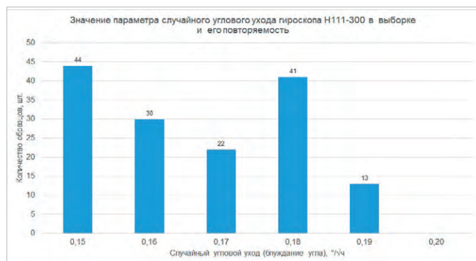
Рис. 4. Случайный угловой уход (блуждание угла) гироскопа
