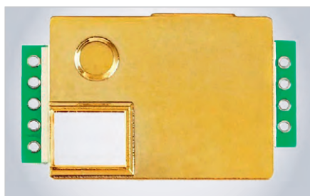
Рис. 15. Внешний вид модуля МН-Z19 для замера CO_2
