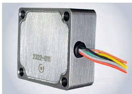
Рис. 1. Внешний вид гироскопа Н111-300
