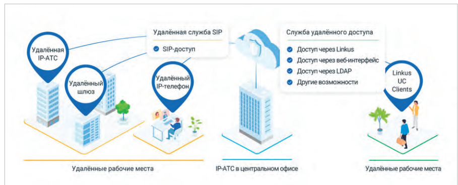
Рис. 10. Структурная схема автоматической системы корпоративной связи
