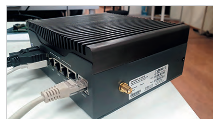
Рис. 12. Внешний вид бортового компьютера VPC-3350S производства AAEON
