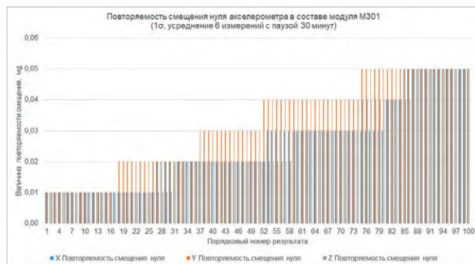
Рис. 15. Повторяемость смещения нуля акселерометра в составе модуля
