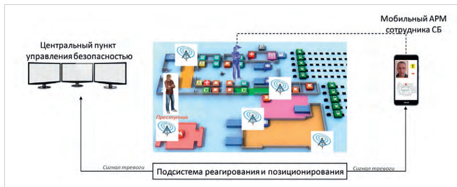
Рис. 5. Схема работы автоматизированной системы безопасности на основе видеоидентификации граждан и документов
