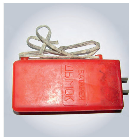
Рис. 6. Электрохимический источник тока для питания световых и звуковых сигналов на воде
