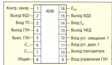
Рис. 5. Нумерация выводов микросхемы CD4046
