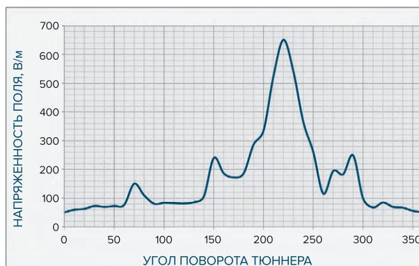
График зависимости напряженности поля от угла поворота «туннера» на частоте 1 ГГц при подводимой мощности 35 dBm
