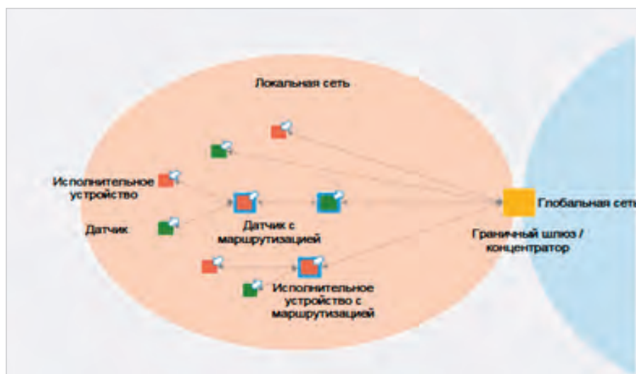
Рис. 6. Архитектура взаимодействия и управления посредством шлюза
