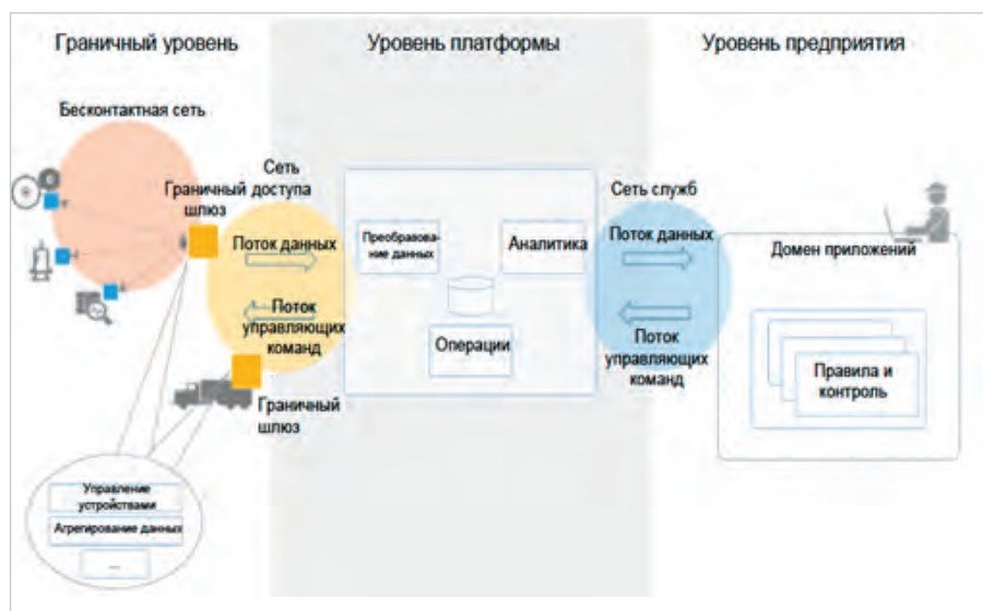
Рис. 4. Трёхуровневая архитектура IIoT
