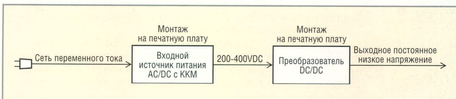
Рис. 2. Структура системы распределения электропитания с входным источником питания АС/DC, установленным на системной печатной плате
