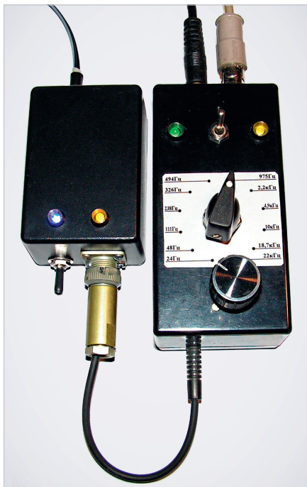
Рис. 8. Общий вид подключённого к ИП генератора в сборе
