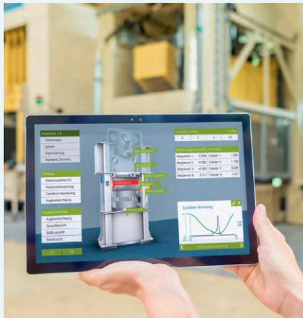
Исследователи из института Фраунгофера продемонстрировали на выставке в Ганновере свою концепцию Maschine 4.0. На реальной демонстрации с полнофункциональным небольшим штамповочным прессом и его цифровым двойником они показали, как именно digitalization (оцифровка) может улучшить производство.
