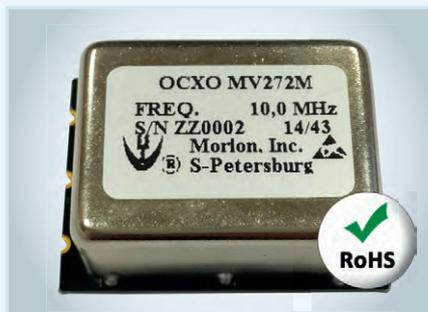
GK272M-TC выпускается в разных модификациях и обладает уникальными характеристиками фазовых шумов и кратковременной нестабильности частоты (девиации Аллана) (см. табл.).
