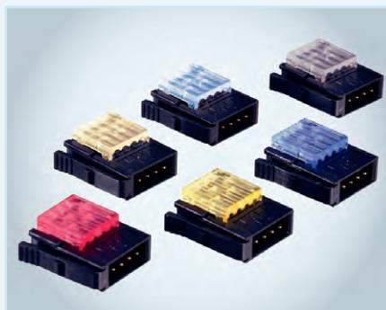
Разъёмы выпускаются на 3 и 4 контакта – это вилки и розетки для монтажа на кабель. Для решений «провод – плата» предлагаются розетки на плату как для SMD-монтажа, так и монтажа в отверстие. К такой розетке можно подключить сразу до четырёх кабельных вилок, что сильно экономит площадь печатной платы. Для эксплуатации разъёмов в условиях повышенной загрязнённости выпускаются также защитные крышки.
