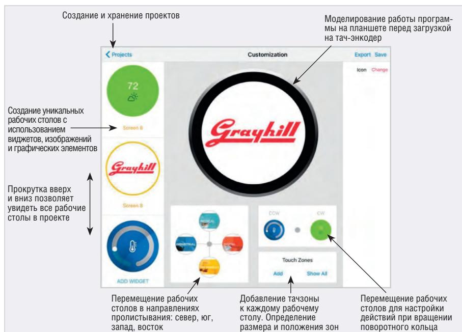
Рис. 5. Пример настройки тач-энкодера с помощью приложения на планшете
