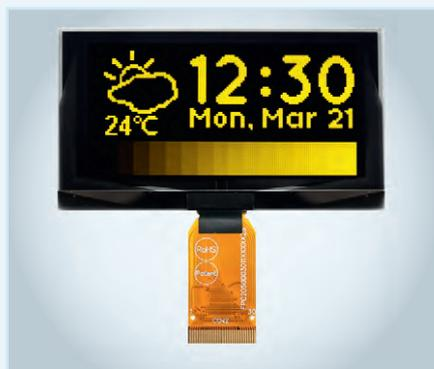
Микросхема контроллера обеспечивает управление контрастом, содержит дисплейное ОЗУ и генератор, а также преобразователь напряжения, что позволяет сократить число внешних компонентов и потребляемую мощность.
