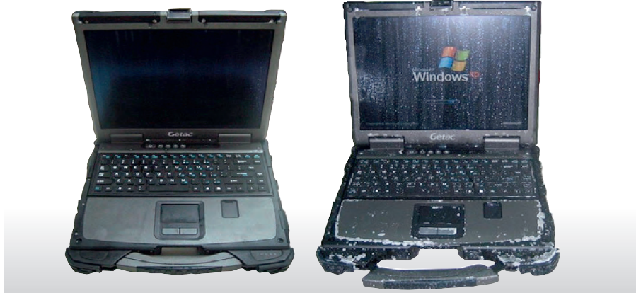
Рис. 7. Наглядная иллюстрация работы технологии антикоррозийной защиты: деталь с покрытием (а) и без него (б) после обработки солью
