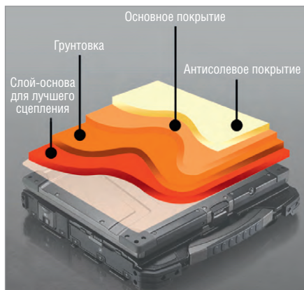
Рис. 6. Структура защитного покрытия корпуса ноутбука
