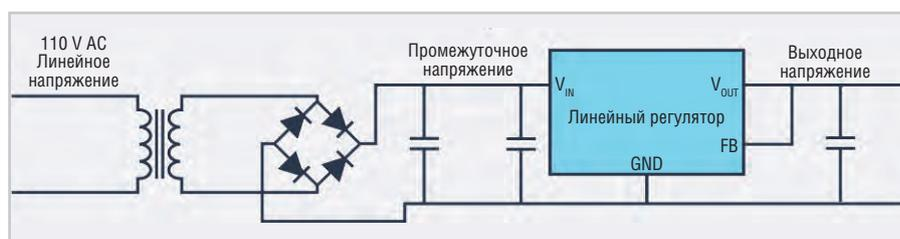
Рис. 2. Линейный трансформатор, за которым следует линейный регулятор
