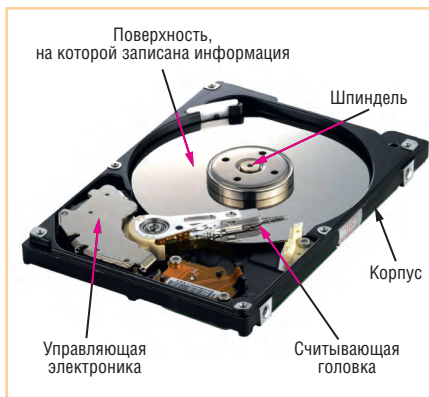
Рис 1. Конструкция НЖМД (со снятой крышкой)
