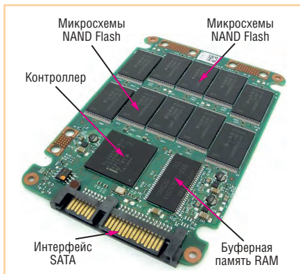
Рис. 2. Конструкция твердотельного накопителя Intel X25-M
